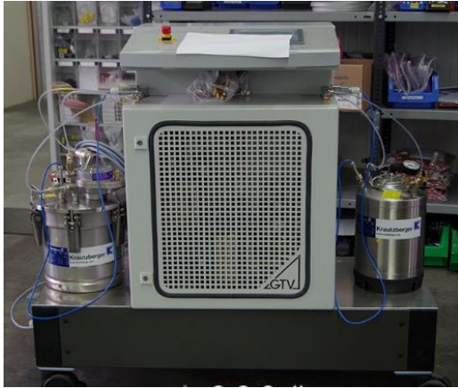
Fig. 2- Hardware de alimentación desarrollado por GTV (izqda). Proceso de proyección del prototipo de cilindro con la suspensión 95%Cr 2 O 3 -5%TiO 2 (derecha)
