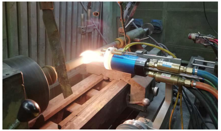
Fig. 2- Hardware de alimentación desarrollado por GTV (izqda). Proceso de proyección del prototipo de cilindro con la suspensión 95%Cr 2 O 3 -5%TiO 2 (derecha)
